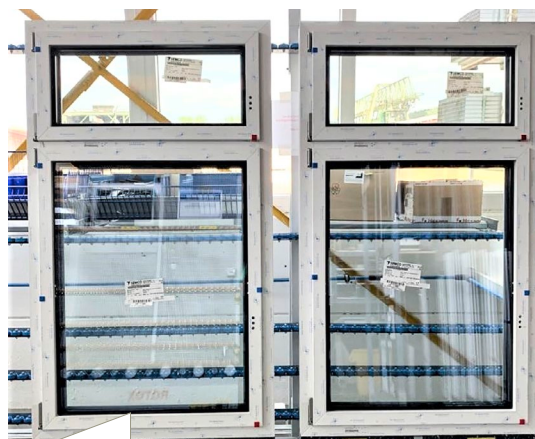
An jedem Element sind die roten und blauen Distanzklötze im geschlossenen Zustand vor dem Verkleben sichtbar.
